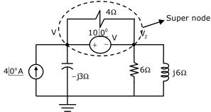
KVL for  $V_1 \& V_2$ :
