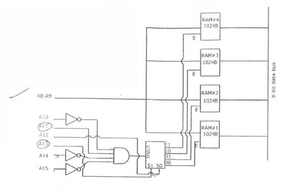
(A) 0C00H-0FFFH, 1C00H-1FFFH, 2C00H-2FFFH, 3C00H-3FFFH (B) 1800H-1FFFH, 2800H-2FFFH, 3800H-3FFFH, 4800H-4FFFH (C) 0500H-08FFH, 1500H-18FFH, 3500H-38FFH, 5500H-58FFH (D) 0800H-0BFFH, 1800H-1BFFH, 2800H-2BFFH, 3800H-3BFFH
