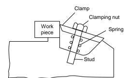
Figure 4.11 : Edge Clamp or Side Clamp
