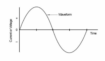
Fig. 2: AC Waveform
