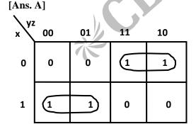
$f(x, y, z) = \overline{x}y + x\overline{y}$
